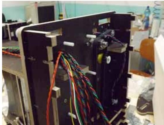
1. Fissare i due finecorsa cavo rosso alla parete laterale destra lato ruvido ponendo un distanziale di legno rettangolare, tramite due viti M3X20 testa a brugola per finecorsa.
