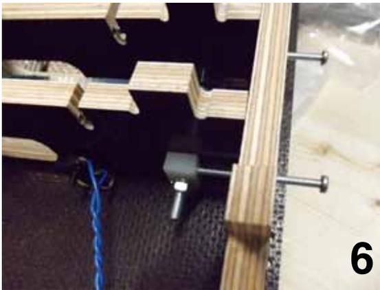
6. con 2 viti M3x25 tendere la cinghia dell'asse y utilizzando gli appositi fori sul lato B-Posteriore e i fori sui pezzi in nylon presenti sul tendicinghia.
